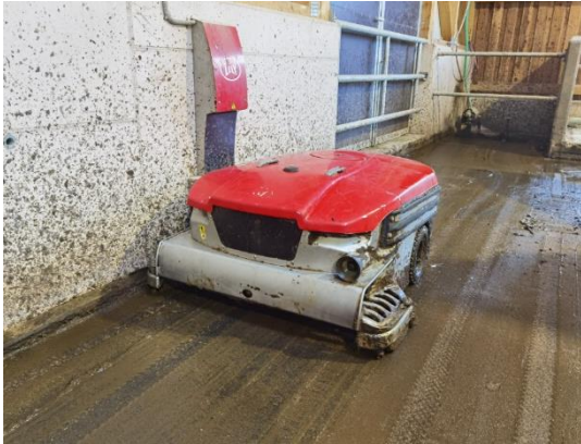
Abbildung 5: Die Flächenleistung wird nicht so sehr von der Akkuleistung bestimmt, sondern vielmehr von der Routenlänge. Wird zwischendurch Flüssigmist über einen Spaltenboden abgegeben verlängert sich die maximal mögliche Route.
