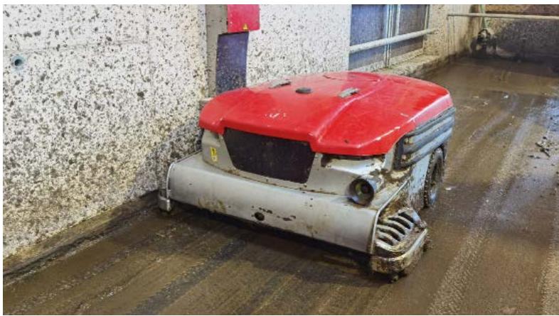
Stromtankstelle: Am Ende seiner Route fährt der Roboter die Ladestation an. Die Flächenleistung wird dabei weniger von der Akkukapazität als von der Routenlänge bestimmt.
