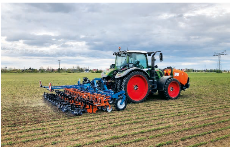
Mithilfe der Bandspritzung kann eine Reduktion des chemischen Pflanzenschutzes um rund 73% realisiert werden.
