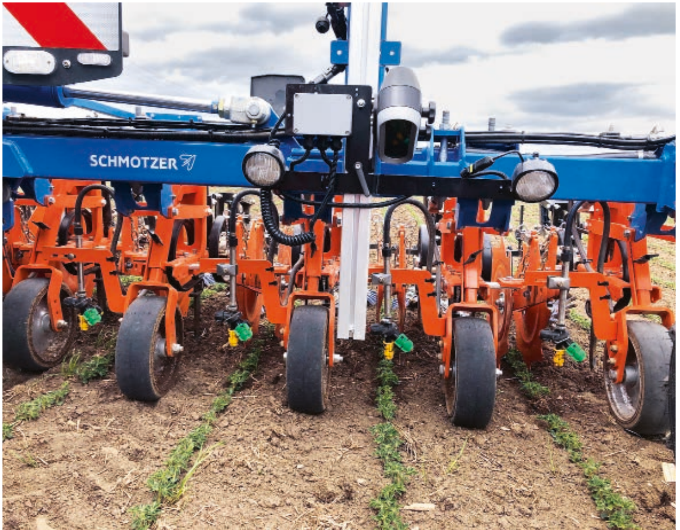
Fingerhacke von Schmotzer in Kombination mit einer Bandspritz-Einrichtung. Bilder: Innovation Farm
