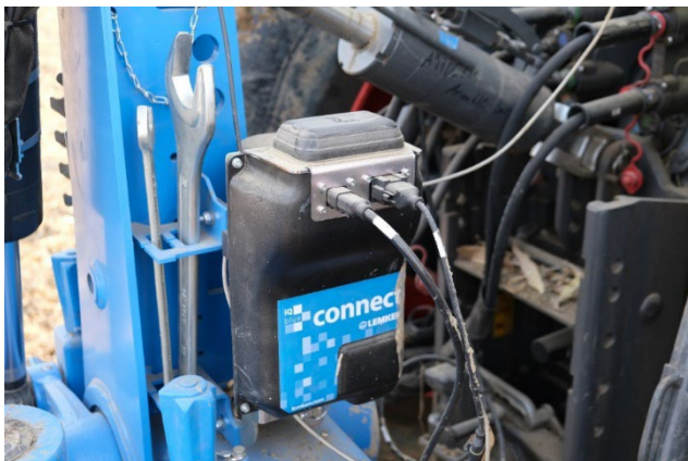
Abbildung 1 iQblue connect Steuerung am Anbauturm
