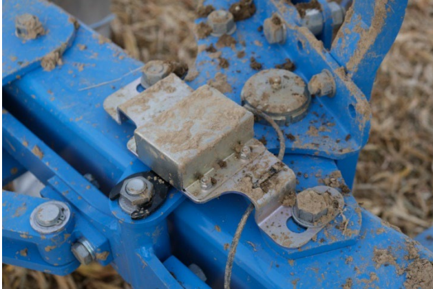
Abbildung 2 Drehwinkelsensor am Pflugrahmen
