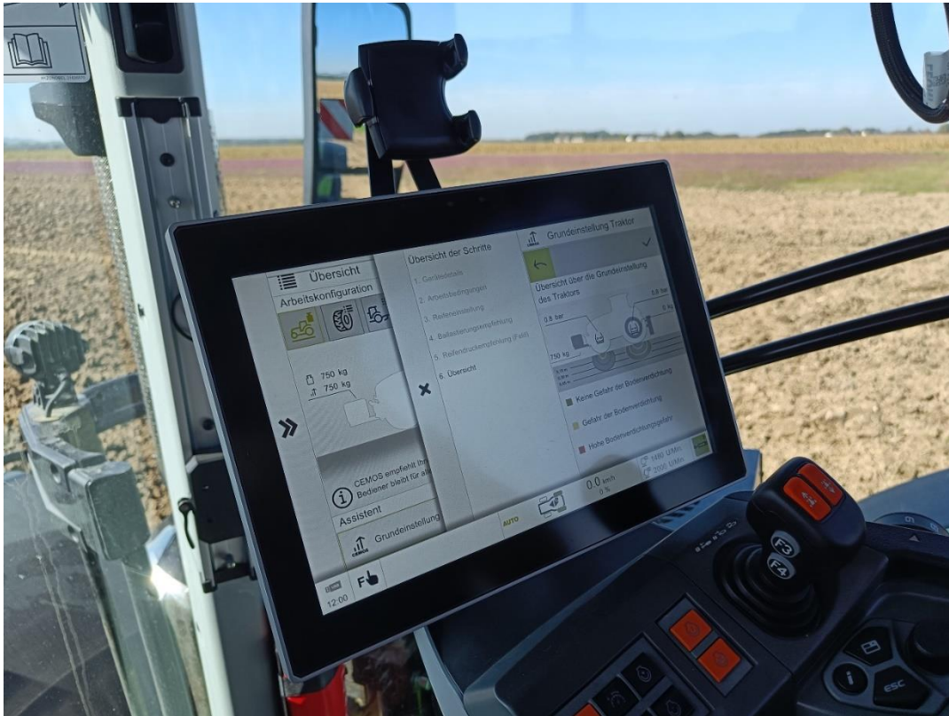
Abbildung 1: Vorschlag zur Ballastierung (750 kg) und Reifendruck (0,8 bar)
