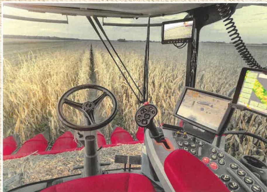
Vier Strategien bietet das Terminal im Axial Flow dem Fahrer an.
