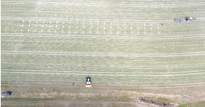
Abbildung 1: Zur Überprüfung der Querverteilung am Hang wurden 3 Wiederholungen durchgeführt. Bei einer Überfahrt wurde die vollständige Wurfweite des Streuers auf dieser Arbeitsbreite überprüft.
