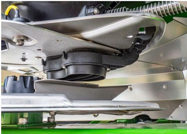
*Bildunterschrift 3: Bei dem Hangstreu-Set handelt es sich um ein Element, das unterhalb der Schieberkulisse montiert werden kann. Dies ist auch nachträglich bei älteren Maschinen möglich.*
