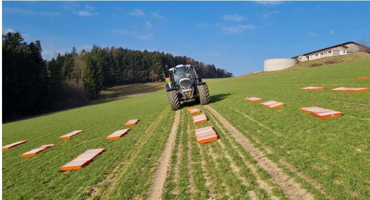
Abbildung 4: Bei dem Versuchsaufbau wurde darauf geachtet, dass die Fläche eine gleichmäßige Neigung über die gesamte Wurfweite hinweg, aufwies.
