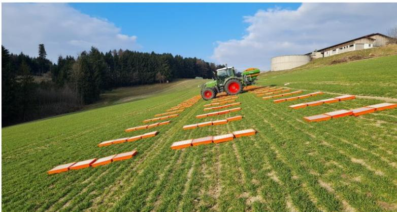
Abbildung 2: Bei der Bergauf- & Bergabfahrt wurde die Querverteilung bei einer Hangneigung von 9 Grad bzw. 16 % überprüft.
