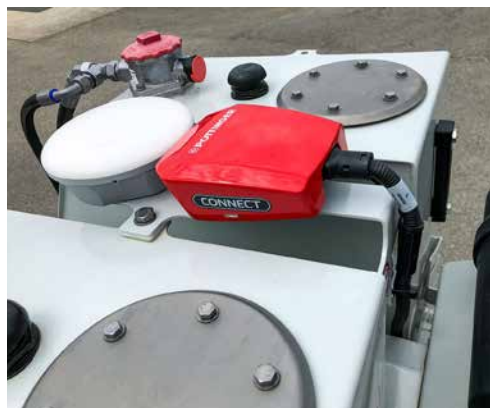
Pöttinger Connect Kommunikationseinheit mit optionalem GNSS Empfänger
