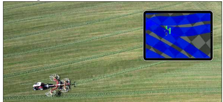
Linker vorderer Kreisel ausgehoben. Da die Testfläche mit einer Schwadzusammenführung gemäht wurde, verbleiben graue Bereiche zwischen den Fahrspuren.
