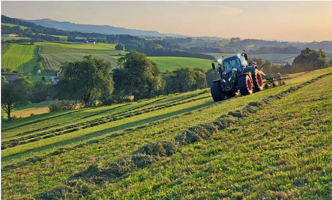
Spurführung und exaktes Arbeiten am Hang ohne Abdrift? Die Funktion „Implement Slope Compensation“ korrigiert den Kurs des Anbaugerätes abhängig von der Hangneigung.
