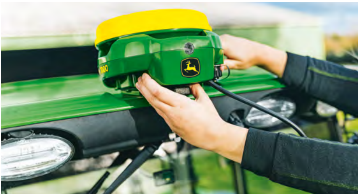
Als Versuchstraktor wurde ein John Deere «6130R Ultimate Edition» mit «JD-Link»-Modul und einem «Star Fire 6000» inklusive Mobile-RTK eingesetzt. Bilder: John Deere
