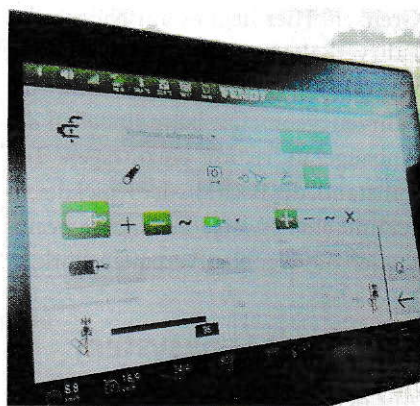
Das Einstellen von Anbaugeräteparametern und der Implement Slope Compensation mittels Schieber in FendtONE.
