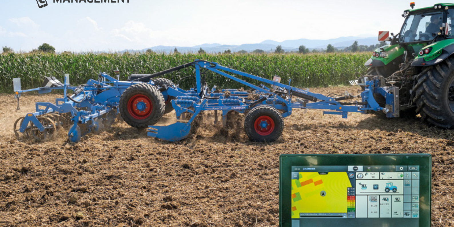
In dem Versuch wurden Auswirkungen auf die Flächenleistung und den Kraftstoffbedarf durch eine variable Arbeitstiefe untersucht. Fotos: Krippel
