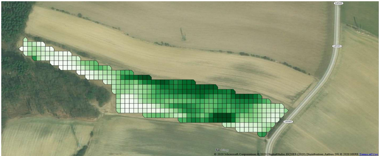
Abbildung 1: Anhand von Vegetationsindizes, die u.a. von Satellitenaufnahmen stammen, können Rückschlüsse auf die verfügbare Biomasse gezogen werden und unterschiedliche Zonen aufzeigen.
