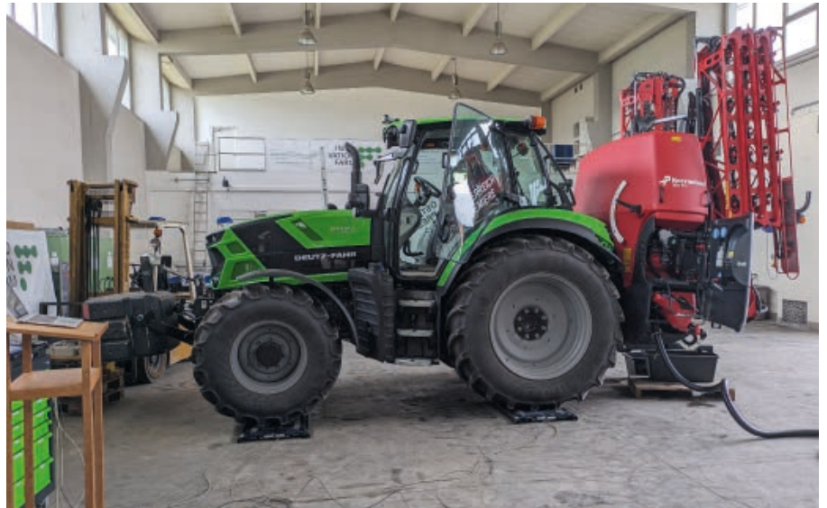
Der Traktor mit dem Multitank-System wird für die Versuchsarbeiten vorbereitet.
