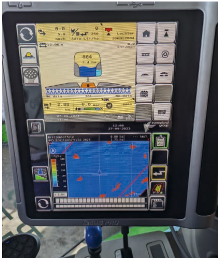
Durch die geteilte Darstellung werden zwei Isobus-Oberflächen am Terminal übereinander dargestellt.
