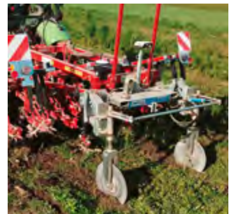
Die Spurführung wird durch die Sech-Scheiben sichergestellt.
