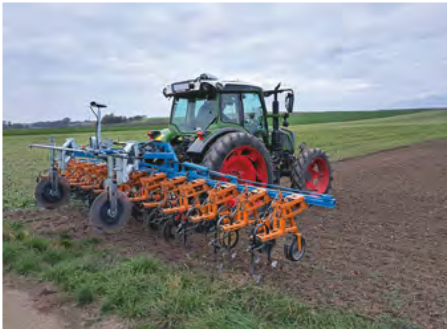
Das System «Twin-Disc» mit den beiden beweglichen Sech-Scheiben von Raven kann hinter fast jedes Anbaugerät angeflanscht und von Gerät zu Gerät gewechselt werden.
