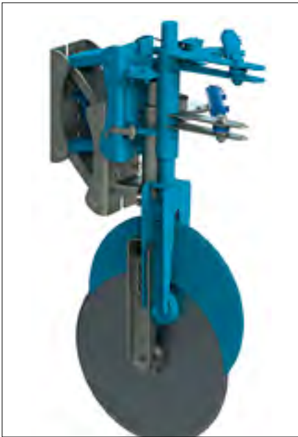
Schematische Darstellung der Sech-Scheibe mit der Überlastsicherung. Bild: Raven
