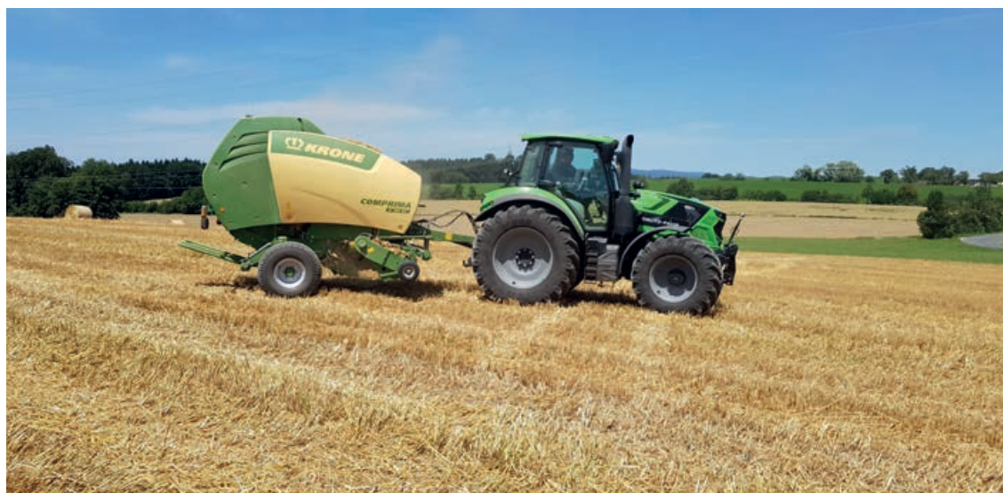
Dieses TIM-taugliche Gespann aus Deutz-Fahr 6155.4 TTV und Krone Comprima V150 XC wurde für diesen Versuch eingesetzt.
