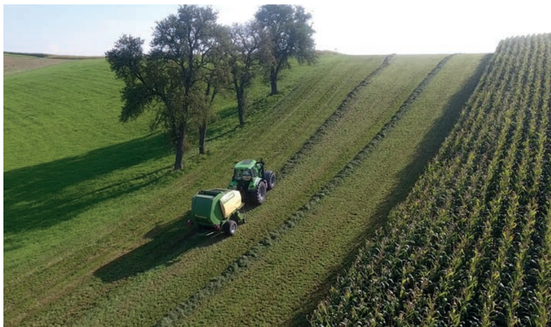
Am Hang erfolgt die Ballenablage wie gewohnt nur auf der Kuppe oder beim Einknicken der Presse über 90° (sodass das Heck leicht hangaufwärts schaut).
