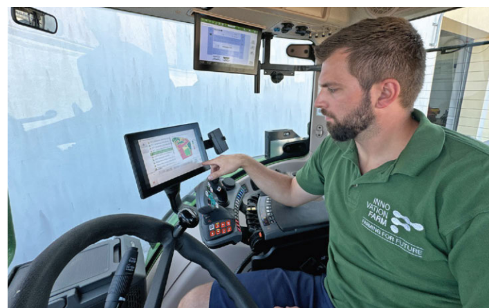
Getrennte Bedienung von Anbaugerät und Traktor durch FendtONE
